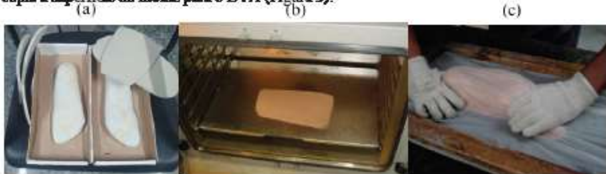
Figura 3: Molagem do EVA: (a) molde positivo e EVA, (b) EVA no forno e (c) sucção do EVA no molde. Fonte: Adaptação de Brasil, 2014.
