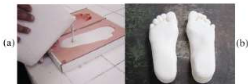
Figura 2: Produção do molde positivo: (a) preenchimento da espuma com gesso e (b) molde positivo. Fonte: Brasil, 2014.
