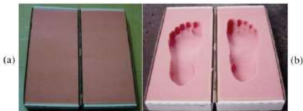
Figura 1: Produção do molde negativo: (a) caixa de espuma copiadora e (b) molde negativo do pé. Fonte: Brasil, 2014.
