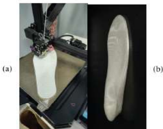
Figura 7: Impressão da palmilha: (a) palmilha sendo impressa e (b) palmilha impressa. Fonte: Autores.
