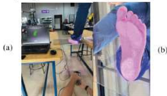
Figura 5: Processo de escaneamento: (a) scanner sendo utilizado e (b) vista posterior do pé ao ser escaneado. Fonte: Antares.
