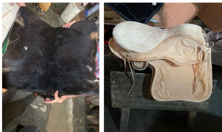
Figura 3: Couro de bode, utilizado na parte inferior da sela (esquerda) e sela pronto (direita). Fonte: Arquivo dos autores.
